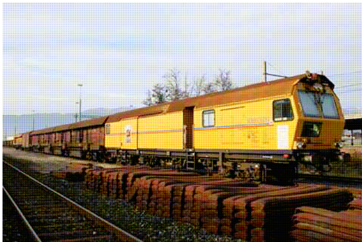
Train meuleur de rails (Scheuchzer S.A.)
